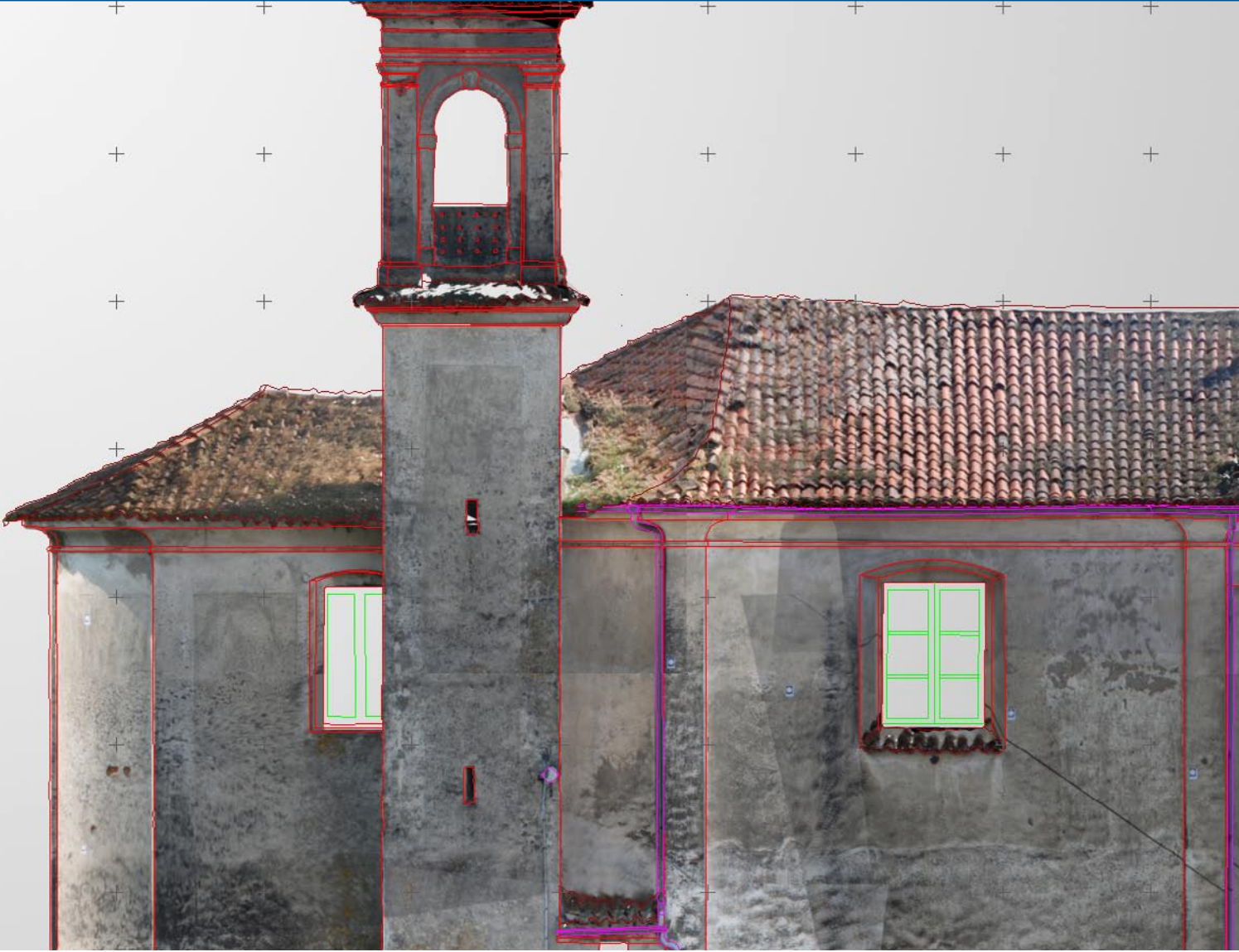
CAD dijitalleştirilmesi için ortografik AutoCAD görünümü
